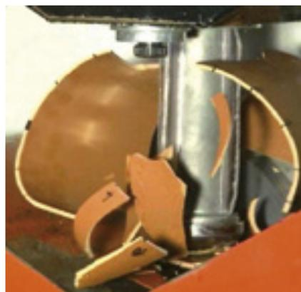
*Schaumkernrohre können bei niedrigen Temperaturen splintern. Was hier beim sogenannten „Kugelfalltest“ klar erkennbar ist, bringt auch dem Verleger in der Praxis erhebliche Nachteile und Gefahren.*
