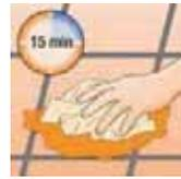
Innerhalb 15 Min. Überschuss, Streifen, Pfützen verteilen oder vollständig entfernen
