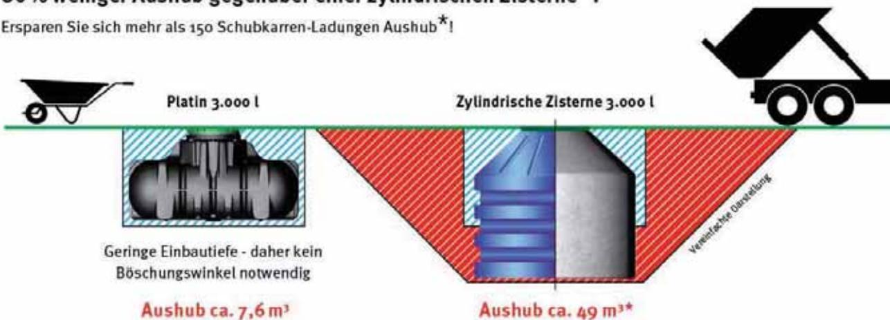
\* Ausgehend von einer stehenden, zylindrischen Zisterne mit Nutzvolumen 3.000 Liter, einer Höhe von 1,90 m und einem Durchmesser von 2,20 m. Berechnung des Aushubs unter Berücksichtigung einer Grubensohle von 10 cm, einem seitlichen Arbeitsraum von 50 cm sowie einer Böschung mit 45° Neigung gemäß DIN 4124.
