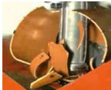
*Schaumkernrohre können bei niedrigen Temperaturen splintern. Was hier beim sogenannten „Kugelfalltest“ klar erkennbar ist, bringt auch dem Verleger in der Praxis erhebliche Nachteile und Gefahren.*
