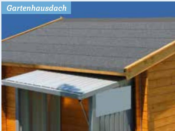
Mit der vollflächig selbstklebenden, ca. 3 mm starken Elastomer-Bitumenbahn decken Sie Ihr Gartenhaus 100 % zukunftsicher und rekordverdächtig schnell ein: Die Bramac Schindelbahn wird ganz einfach waagrecht verlegt und ist die einzigartige Alternative zu Dachschindeln!
